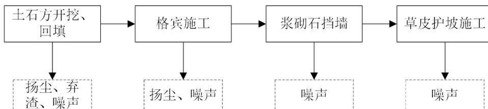
图 2-3 护岸工程施工工艺流程及产污节点图
