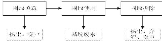
图 2-1 围堰施工工艺流程及产污节点图
