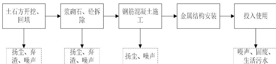
图 2-2 水闸施工工艺流程及产污节点图
