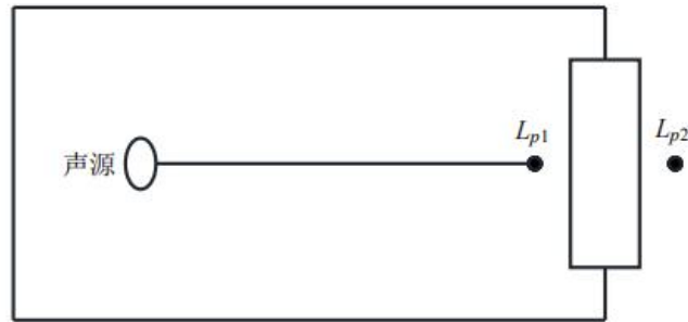
图 4-1 室内声源等效为室外声源图例
